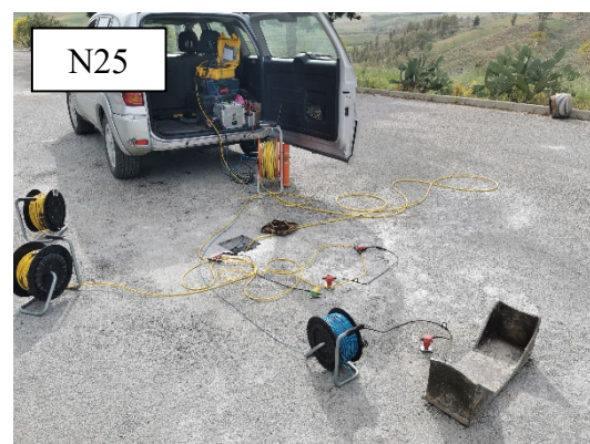
Fig. 7 – Panoramica delle postazioni di acquisizione Down-Hole
